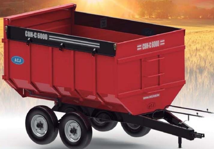
A Carreta CHB-C 6000 ACJ possui assoalho em viga rígida de 5mm de espessura com acabamento em chapa lisa de 2,65mm, proporcionando maior escoamento dos produtos. Possui chassi reforçado em chapa rígida com espessura de 6,3mm, garantindo maior durabilidade.
